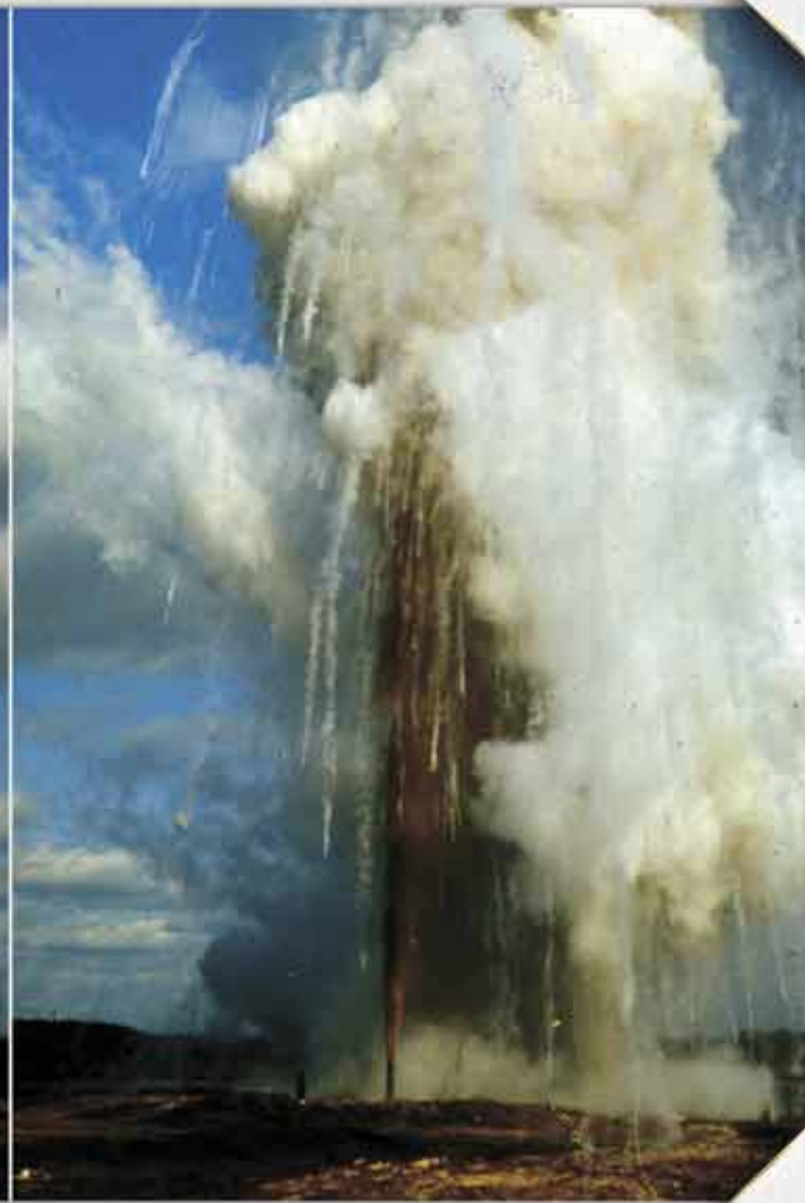
Фото, демонстрирующее принципиально новый высокоэффективный способ тушения пожаров газонефтяных фонтанов, возникающих при авариях на скважинах. Тушение пожара по этому способу осуществляется путем импульсного воздействия на факел воздушным вихревым кольцом, заполненным распыленным огнетушащим порошком
