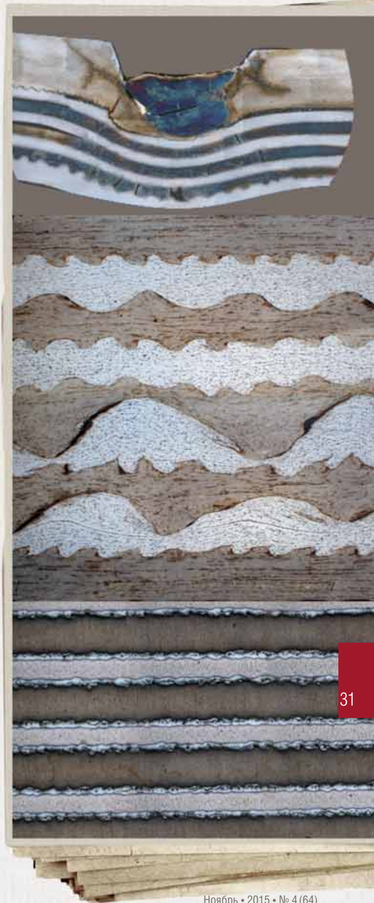
Сваркой взрывом были получены заготовки триметалла титан-ниобий-титан, из которых изготовлены сопловые насадки ракетного двигателя для космического корабля «Луна-16»
